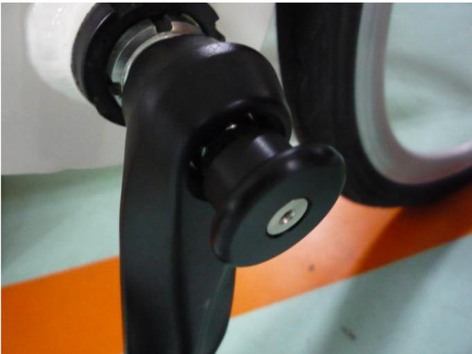
3. 開始調整變速鈕鎖入的深度(原速時,變速鈕與曲柄大約距離)
